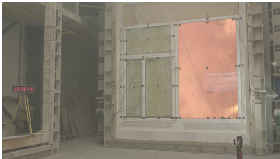
Das EgoKiefer Holz/Aluminium Brandschutzfenster, nach EI30 geprüft, garantiert eine Feuersicherheit während mindestens 30 Minuten.
