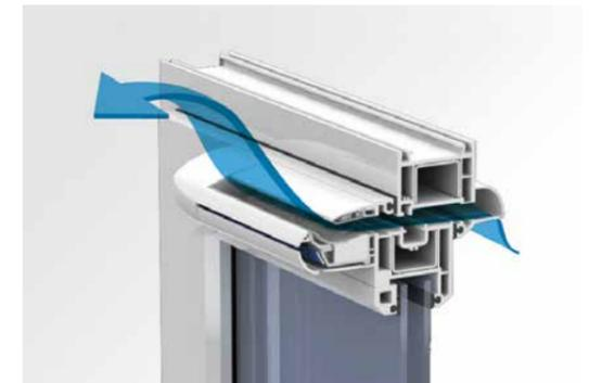
SECCO-Plus – die einfache Abluftanlage
