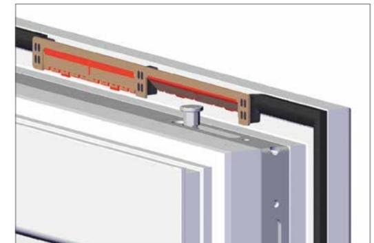
Fensterfalzlüfter arimeo – das einfach unsichtbare Lüftungssystem
